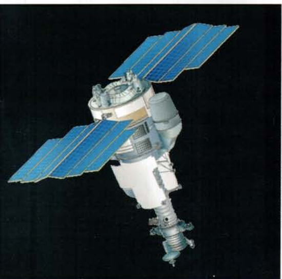
Der PAMELA-Detektor befindet sich an der Außenseite des russischen Satelliten Resurs DK1. Er kann Antiteilchen wie etwa Positronen messen und sie von den entsprechenden Teilchen unterscheiden.
