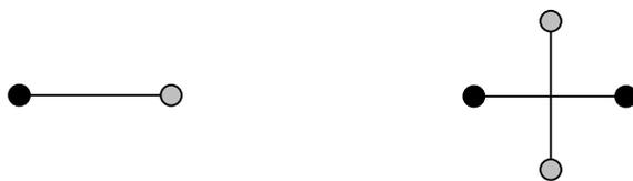
Abbildung I.11: einfachste Anordnungen für elektrischen Dipol und Quadrupol
