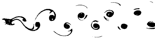
Abbildung 4.5: Kármán'sche Wirbelstraße (aus: M. Van Dyke: An Album of Fluid Motion , The Parabolic Press, Stanford CA, 1982)
