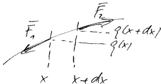
Die Spannung in der Saite ist überall in etwa gleich:  $|\vec{F}_1| = |\vec{F}_2| = F$
