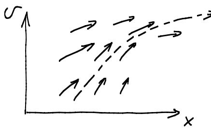
Bei ges. Startptl. ist eine solche Kurve stets (durch das Vektorfeld!) definiert. Sie beschreibt die Bewegung im "Phasenraum"  $(v, x)$  [eigentlich  $(p = mv, x)$ ].
