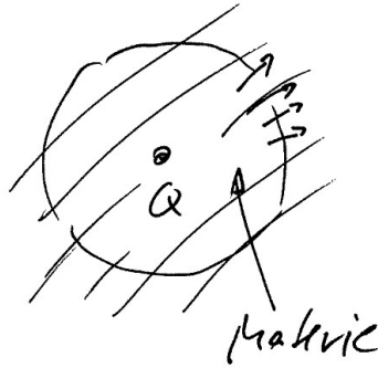
Abbildung 75: Eine Ladung Q in Materie erzeugt ein per Definition materieunabhängiges \vec{D} , z.B. auf der skizzierten Sphäre um Q . Der messbare Feldwert auf dieser Sphäre ist durch \vec{E} \neq \vec{D} charakterisiert.
