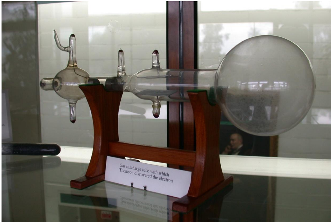
Die Gasentladungsröhre, mit der Thomson das Elektron entdeckte.
