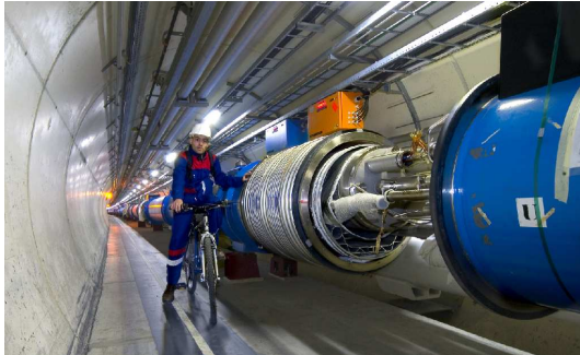
27 Kilometer supraleitende Magneten (gekühlt mit flüssigem Helium)
