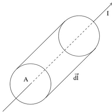
Abbildung 2: Stromdurchflossenes Leiterelement
