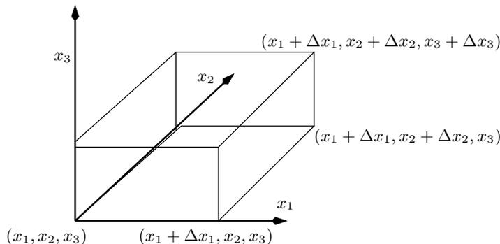
Wollen wir die Divergenz  $\operatorname{div} \vec{E}$  ähnlich wie  $\operatorname{rot} \vec{B} = \vec{\nabla} \times \vec{B}$  durch Ableitungen ausdrücken, betrachten wir dazu praktischerweise einen Quader (s. obige Abbildung) mit infinitesimalem Volumen und berechnen  $\int_A d\vec{A} \cdot \vec{E}(\vec{r})$  über die Quaderoberfläche. Gegenüberliegende Seiten (hier zuerst die Seiten in bzw. parallel zur 1-2-Ebene) liefern aufgrund des Mittelwertsatzes der Differentialrechnung
