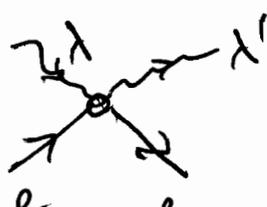
Frequenzverschiebung  $\Delta\lambda = 4\pi \left( \frac{\hbar}{mc} \right) \sin^2 \frac{\theta}{2}$
