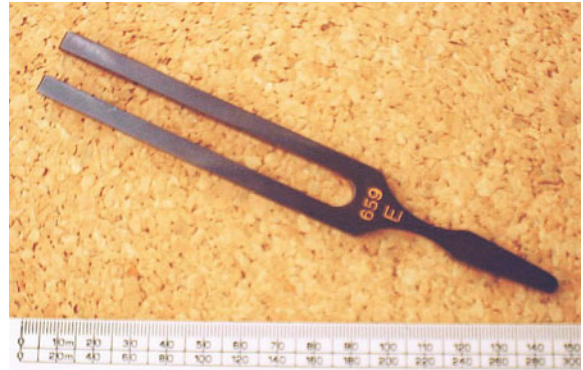
Stimmgabeln sind so konstruiert, dass ihre Resonanzfrequenz genau festgelegt ist – hier bei exakt 659 Hertz, was dem Ton „E“ entspricht.
