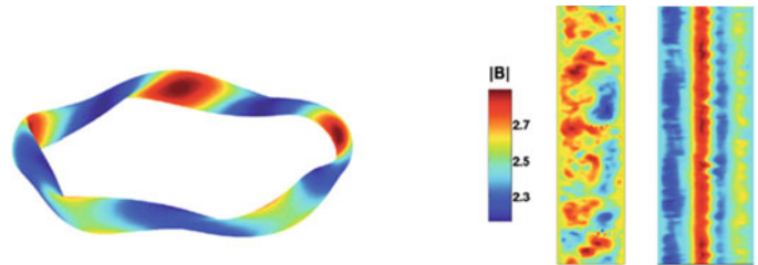
Plasmaidichte für einen typischen Tokamak (links) und Turbulenzen in der Plasmarandschicht für den Stellarator Wendelstein 7-X (rechts)
