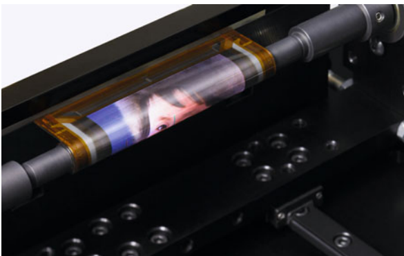
Ein biegsamer Bildschirm, entwickelt von SONY. Er verwendet OLEDs , die dünner als ein menschliches Haar sind.
