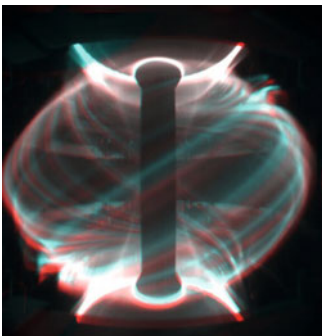
3D-Aufnahme des Plasmas im Forschungsreaktor MAST (Mega Ampere Spherical Tokamak) in Culham, Oxfordshire
