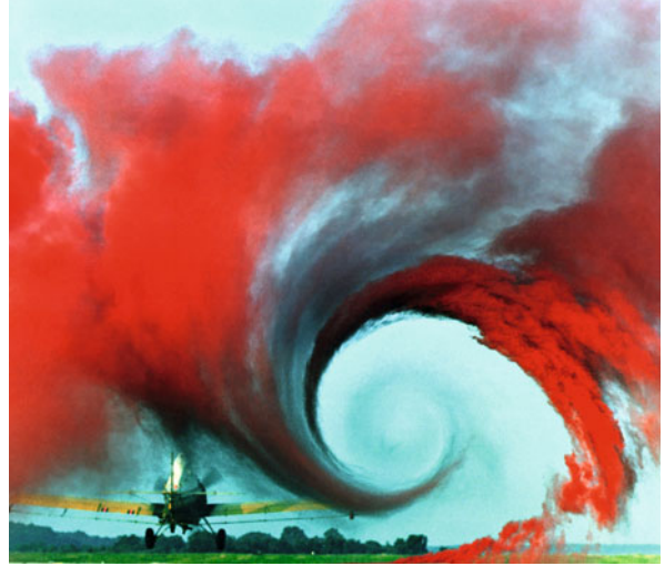
Wirbelschlepe hinter einem Flugzeug, mit farbigem Rauch sichtbar gemacht.
